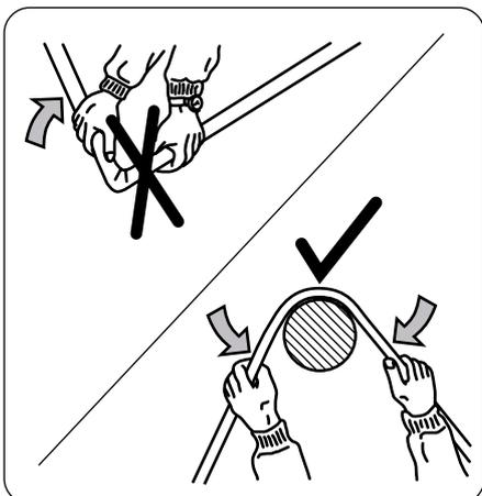
Не допускайте излома или сжатия труб водяных контуров и дренажной трубы.
