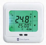
Термостат серии СЕТТ представляет собой микропроцессорный контроллер с жидкокристаллическим сенсорным дисплеем. Термостат предназначен для контроля температуры воздуха в помещении путем управления вентилятором и клапанами с электроприводом в системах охлаждения и обогрева воздуха. З скорости вентилятора могут быть установлены в автоматическом или ручном режиме.
